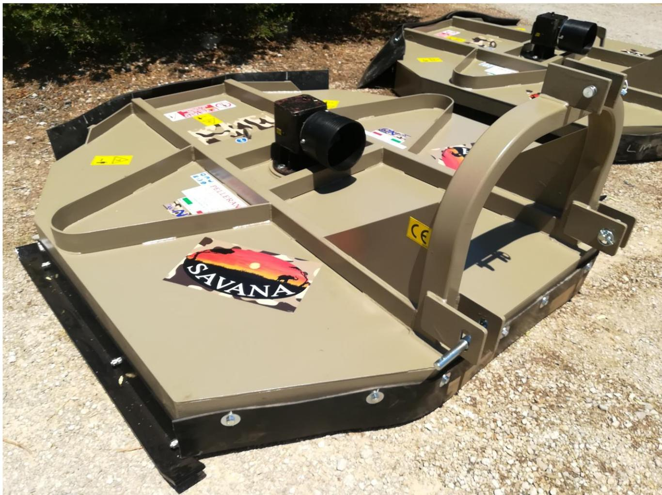
Il trincia a catene mod.ND200 ha come caratteristiche principali un bassissimo assorbimento di potenza e la possibilità di lavoro in presenza di moltissima pietra e scoglio fisso affiorante. Trincia tranquillamente ogni tipo di erba ed infestanti di ogni tipo (acacie, cisto, rovi, canne, etc.) come anche potature di ogni tipo (meglio se ben secca).
