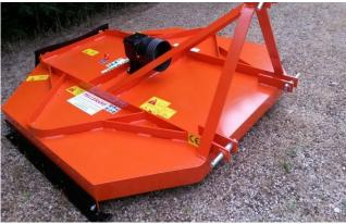
I trincia catena Linea Green Pellerano non sono soggetti al fenomeno dell'ingolfamento presente in tutti gli altri tipi di trincia quando si procede con una velocità d'avanzamento eccessiva. La ragione è molto semplice: la distanza tra gli organi che trinciano è molto grande per cui consente molto "scarico", cioè la fuoriuscita del materiale trinciato.
